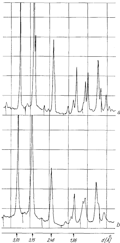
Abb. 3. Zählrohraufnahmen der „scharfen“ und „diffusen“ Form von \alpha\text{-Nb}_2\text{O}_5 ( \text{CuK}_\alpha -Strahlung).
